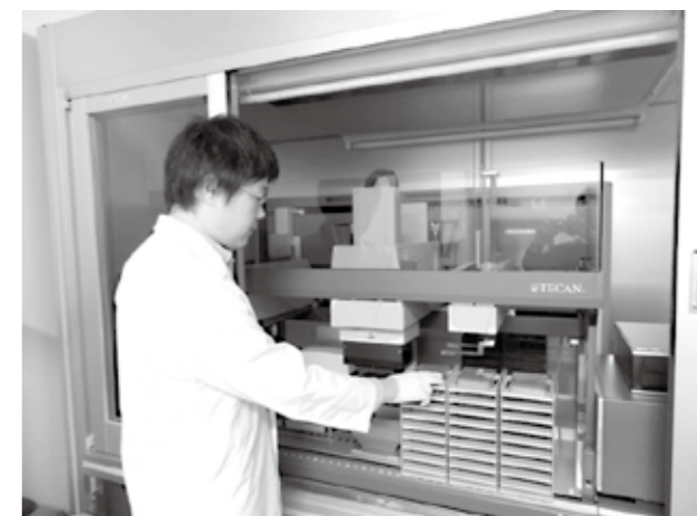
写真2: ハイスループットスクリーニングシステム。バイオフィーム形成阻害剤の大規模スクリーニングの実施
