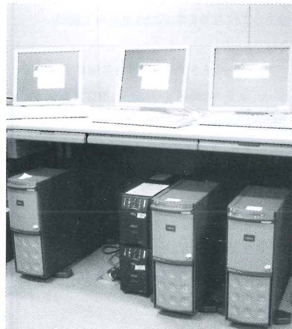
▲e-learning用サーバー（大学1号館SGL室内） 電子教材を学生の自宅での学習並びに卒業者等への生涯学習教材配信を行うための装置
